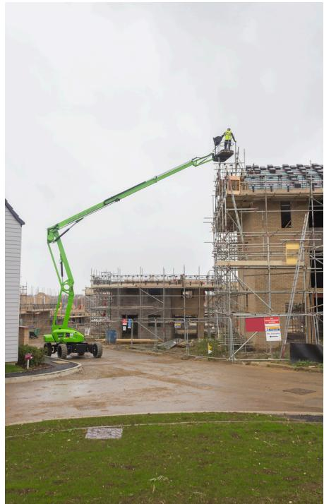
La HR21 4x4 cuenta con espacio para 2 personas y sus herramientas hasta una altura de trabajo de 20'8m o un alcance de trabajo de 13m. Sus controles ofrecen una **operación suave y controlada**, mientras que la rotación de cesta de 160° y una pluma secundaria de 150° permiten un **posicionamiento preciso** en cualquier lugar dentro de su gran ámbito de trabajo.
